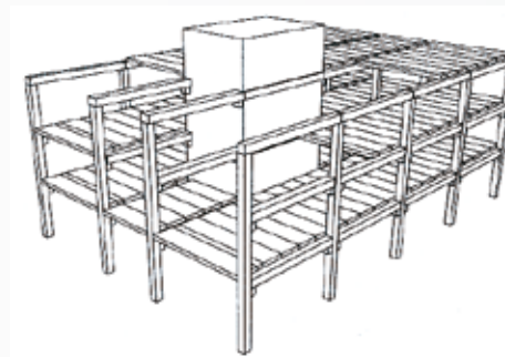
Bâtiment contreventé par noyau central
