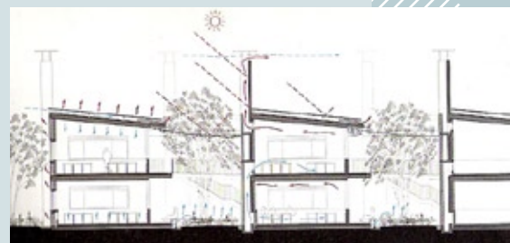
Coupe de principe des cheminées solaires, lycée français de Damas
